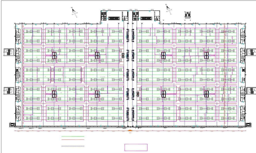
FIG. 3 - Individuazione degli assi degli arcarecci relativi ai padiglioni 8 e 12. In verde le posizioni utilizzabili per l'appoggio delle strutture in elevazione dei soppalchi, in rosso le posizioni non utilizzabili. In blu sono riportate le posizioni degli assi delle travi reticolari di sostegno degli arcarecci, in magenta il perimetro delle aree espositive.
