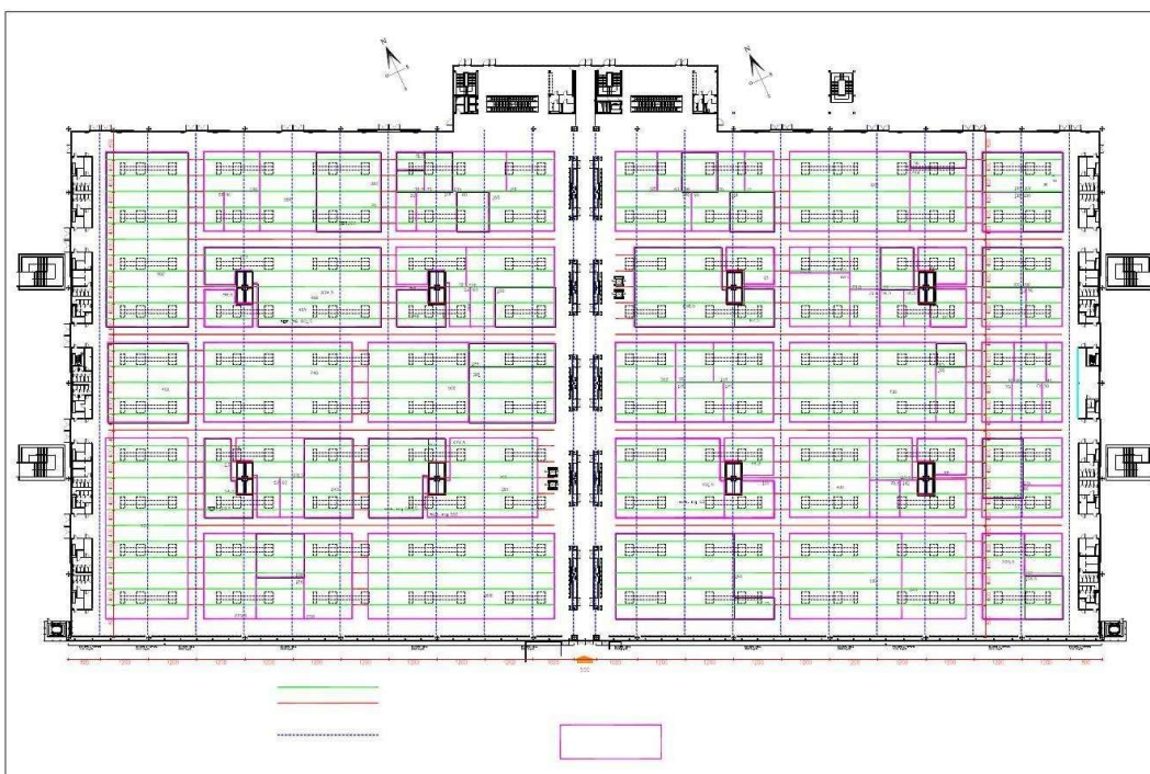
FIG. 4 - Individuazione degli assi degli arcarecci relativi ai padiglioni 16 e 20. In verde le posizioni utilizzabili per l'appoggio delle strutture in elevazione dei soppalchi, in rosso le posizioni non utilizzabili. In blu sono riportate le posizioni degli assi delle travi reticolari di sostegno degli arcarecci, in magenta il perimetro delle aree espositive.
